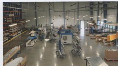
Część hali została wydzielona na część produkcyjną, w której powstają drzwi aluminiowe zabudowy naczepek oraz żaluzje wyposażające pojazdy strażackie
